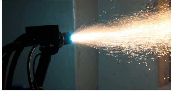
ARCJET ® -101 TWIN WIRE ARC-SPRAY SYSTEM
